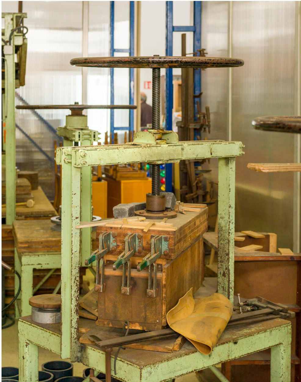
Atelier de thermoformage. Presse et moule de fabrication.
