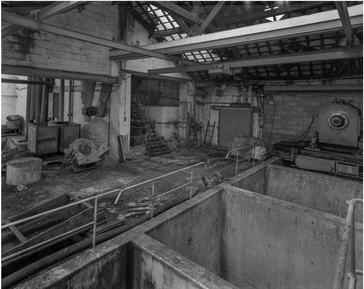
Bâtiment C. Grandes cuves de béton, construites vers 1950, permettant une première étape de macération acide ou alcaline des plantes.
