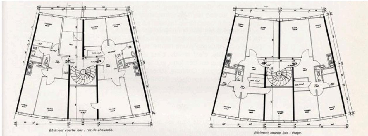
La Noé. Plans du RDC et d'un étage type d'une trame (2 appartements traversant)
