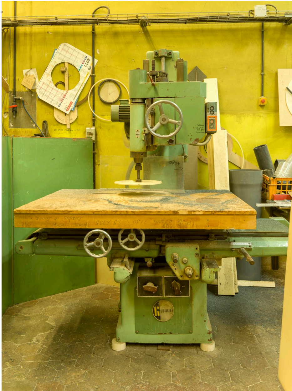
Chaudronnerie plastique. Scie circulaire horizontale.
