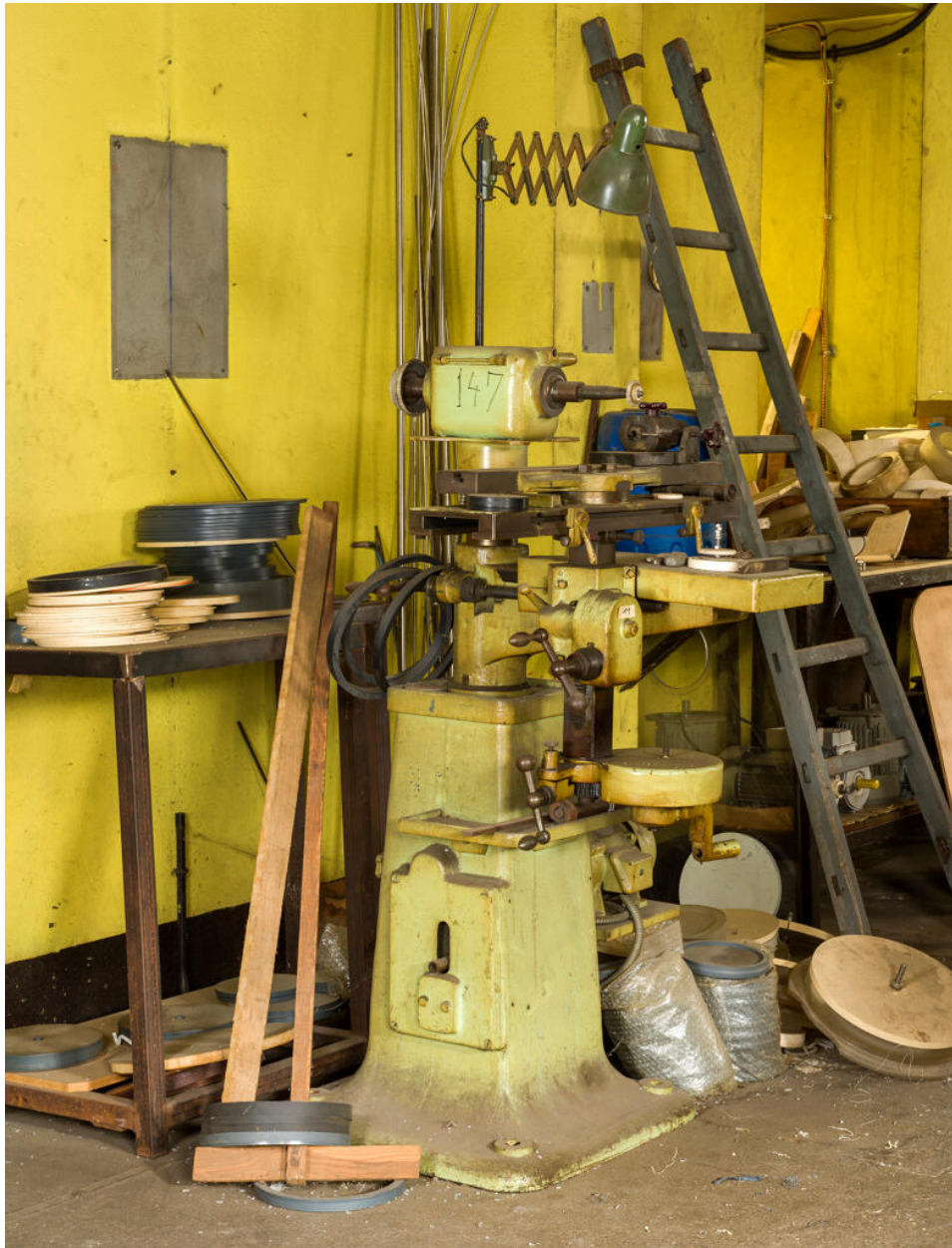
Atelier de mécanique générale (usinage). Affûteuse d'outils.
