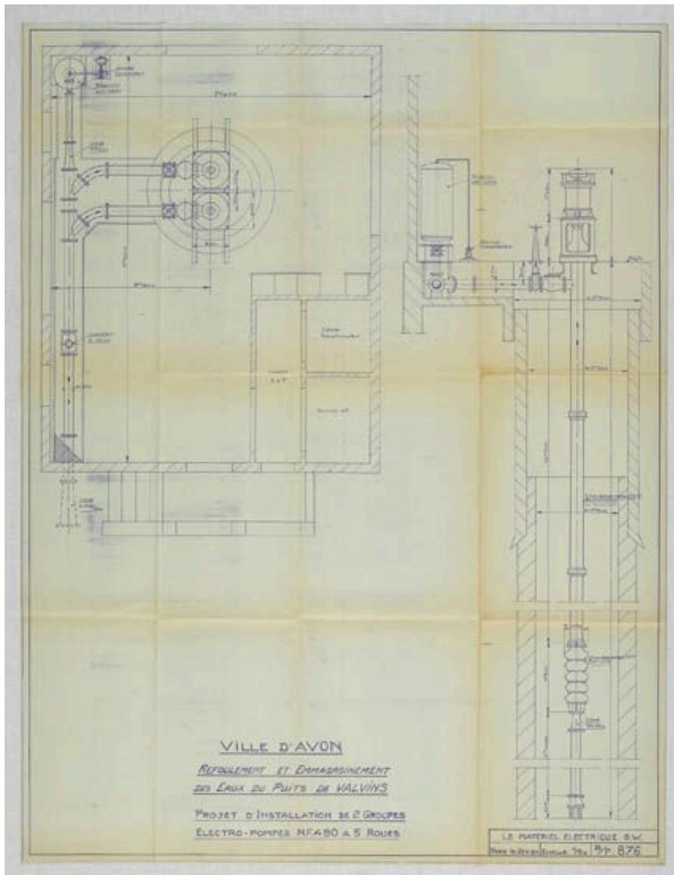
Plan et coupe des groupes électro-pompes installés à la station de pompage de Valvins par Le Matériel électrique S-W en 1954. (AD Seine-et-Marne, 3353W1169 )
