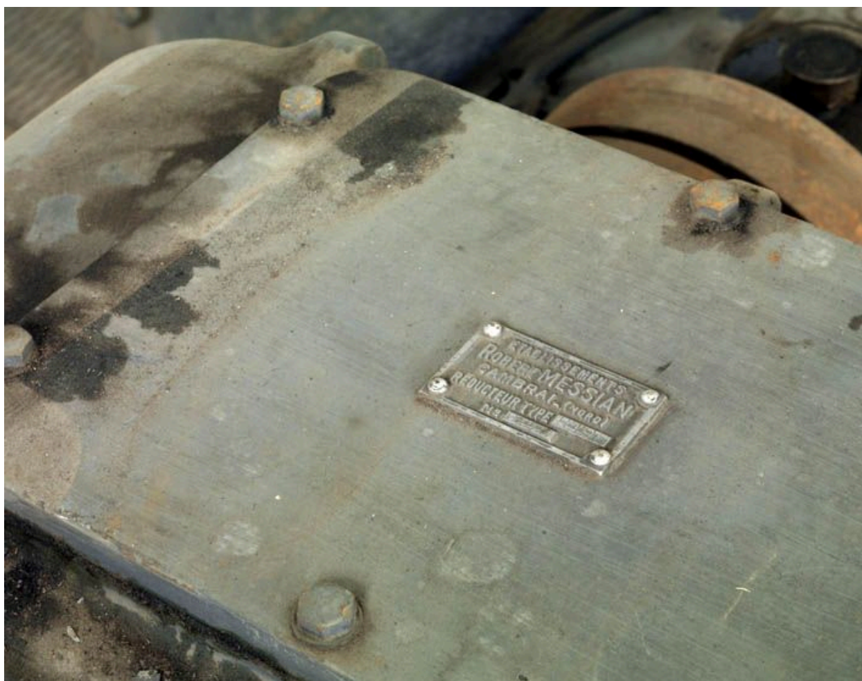
Réducteur type RTOS, plaque de constructeur : établissements Robert Messian, Cambrai.
