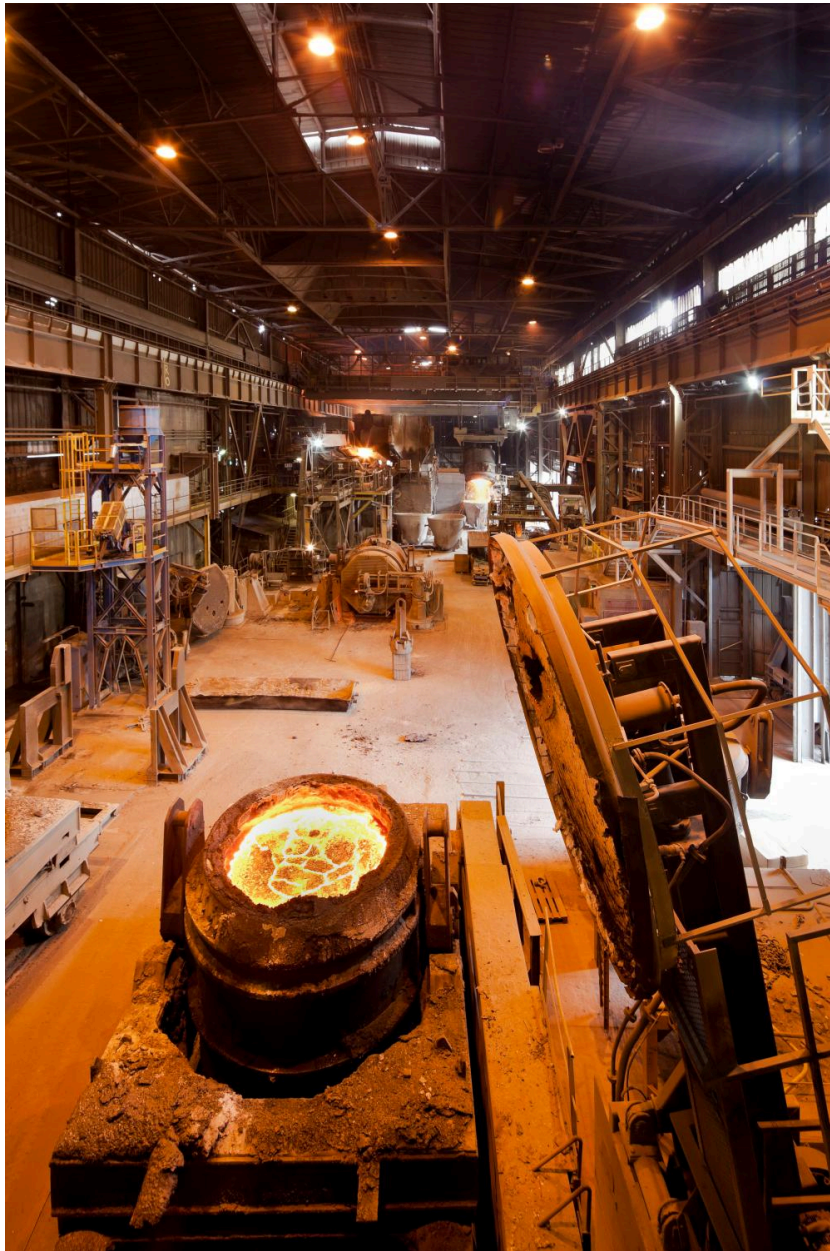
Halle de coulée, avec au premier plan une poche de coulée. (réf. Département Seine-et-Marne : IVD77_2013_77_00243_NUCA)
