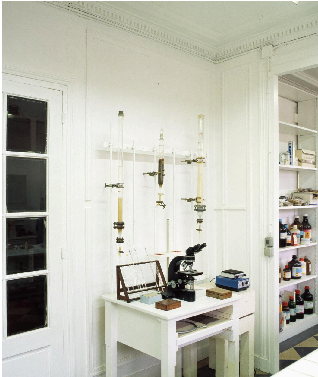
Laboratoire (1er étage du bâtiment G). Colonnes d'extraction, microscope pour le contrôle des adultérations à l'achat des plantes et à droite, vibreur pour des séries de tamis (afin de contrôler la granulométrie des tisanes).
