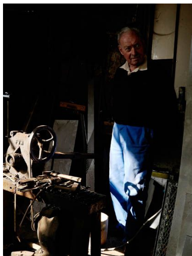
Machine a torsader a froid les sections de fer, mise au point par Mr. Durand. Phot. Philippe Ayrault IVR11_20097701351NUC4A
