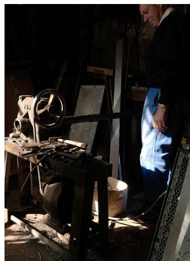
Machine a torsader a froid les sections de fer, mise au point par Mr. Durand. Phot. Philippe Ayrault IVR11_20097701350NUC4A
