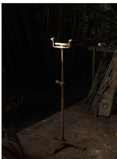
Servante utilisée pour porter l'extrémité non travaillée des sections de fer lors du travail du métal. Phot. Philippe Ayrault IVR11_20097701356NUC4A
