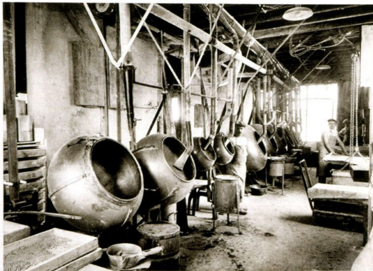
Atelier de dragéification. Plaquette éditée par les Laboratoires galéniques Vernin vers 1930, page 15. (Service archéologique de Melun)
