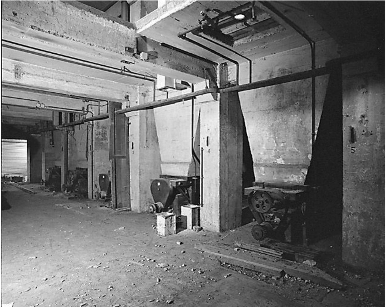
Partie magasin à farine. Au rez-de-chaussée, les trémies des chambres à farine longeant le quai de chargement. A gauche, hors champ, la base du toboggan hélicoïdal de manutention.
