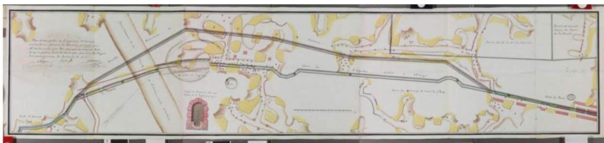
Arcueil. Plan d'un projet de détournement de l'aqueduc Médicis, à la fin du XVIIIe siècle, du fait de nombreuses carrières (Archives nationales) (AN, O/1/1599)
