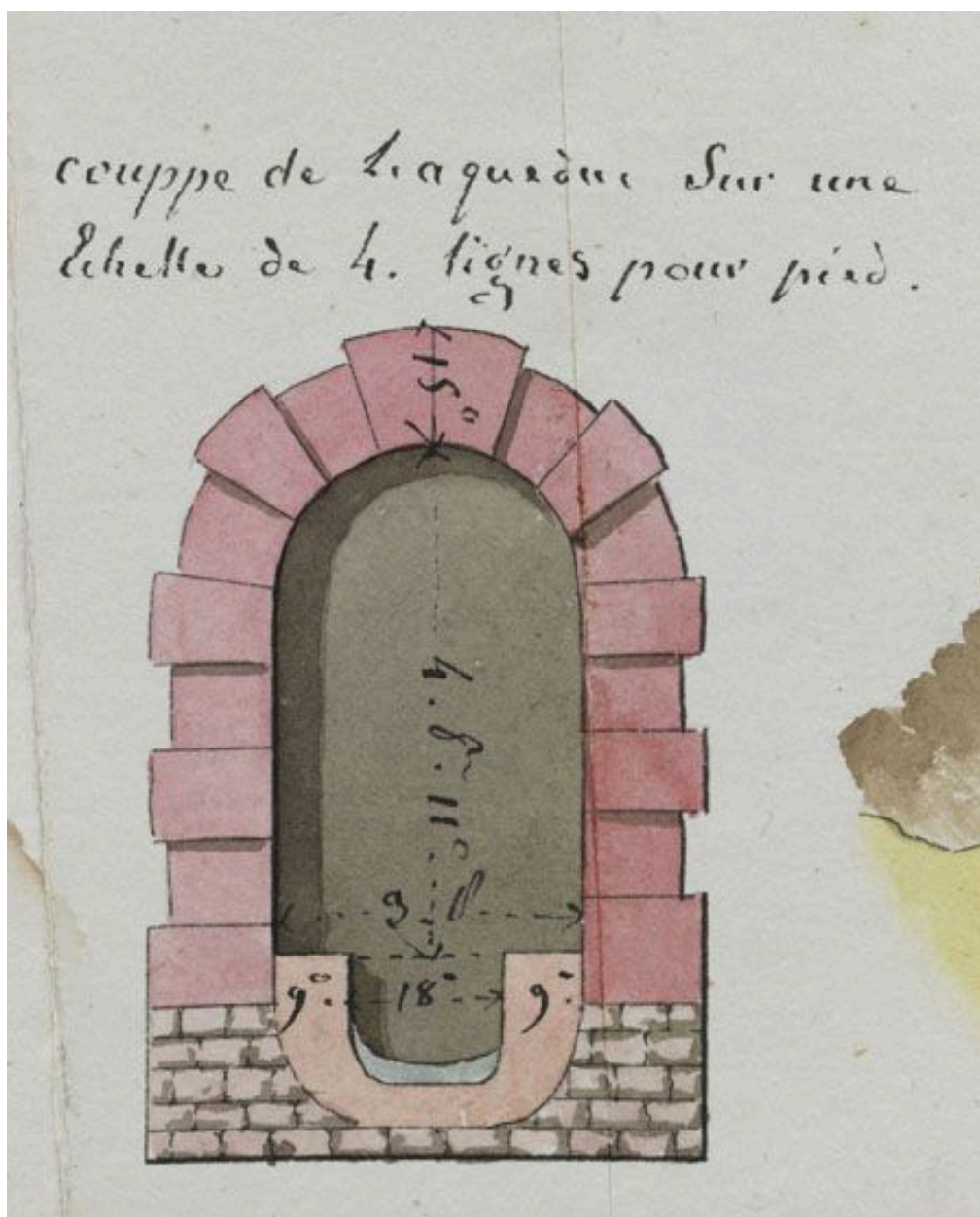
Arcueil. Coupe de la galerie de l'aqueduc Médicis en 1782, avec figuration des banquettes de circulation. (AN, O/1/1599)
