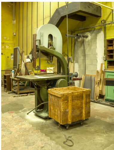
Chaudronnerie plastique. Scie à ruban.
