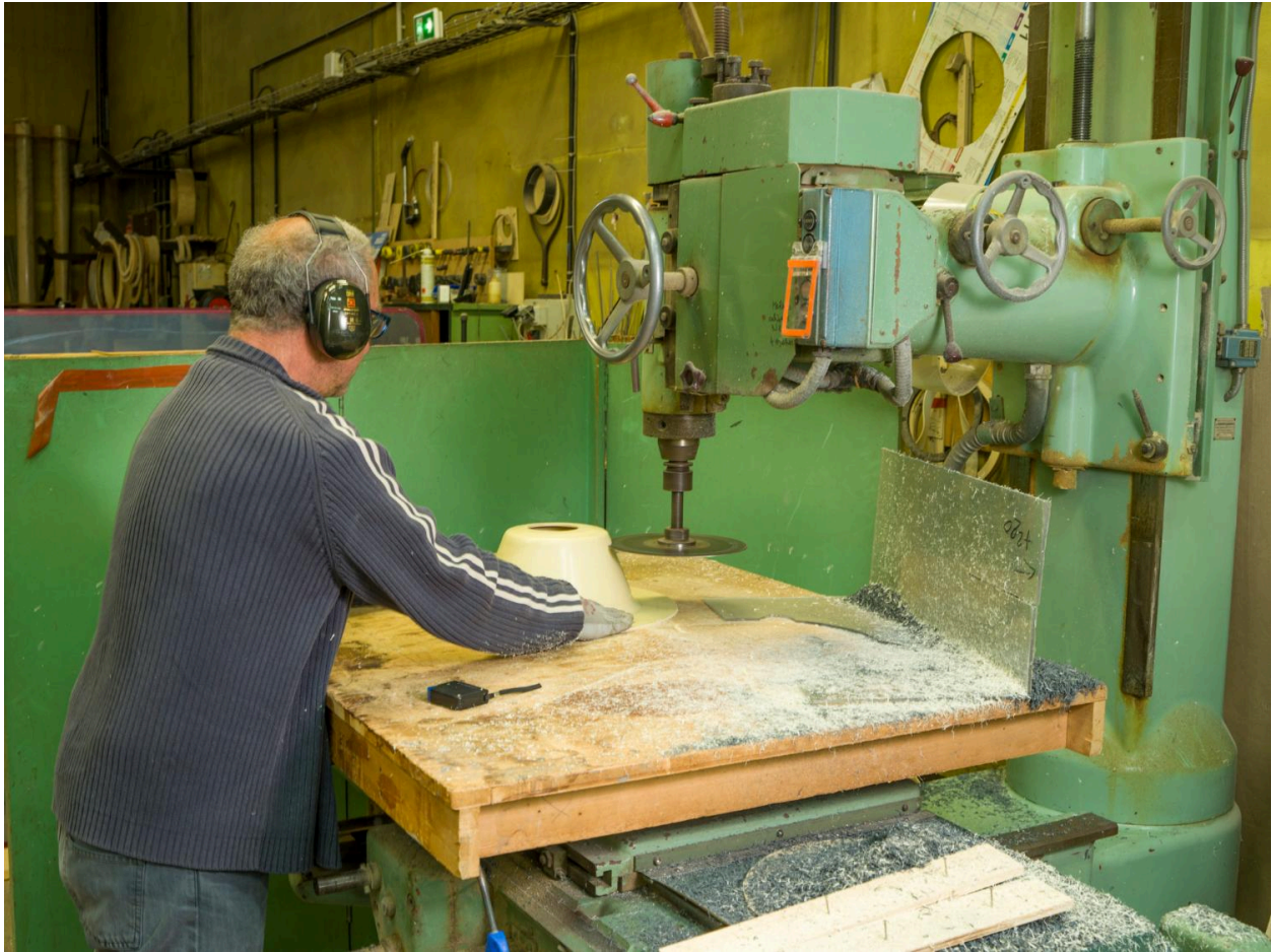
Chaudronnerie plastique. Découpe d'un élément de ventilateur centrifuge en PVC avec une scie circulaire horizontale.
