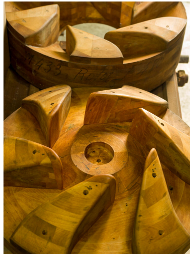
Atelier de thermoformage. Moules en lamellé-collé, usinés à la main au cours des années 1960, pour thermoformer des retors de ventilateurs en PVC d'une épaisseur de 3 millimètres. Phot. Asseline Stéphane IVR11_20239400200NUC4A
