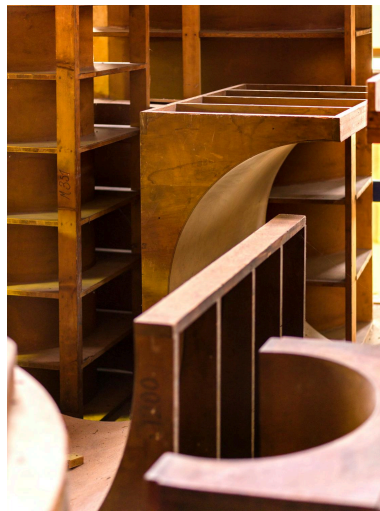
Atelier de thermoformage. Berceaux destinés à la fabrication de pièces cylindriques de grand diamètre. Phot. Stéphane Asseline IVR11_20239400209NUC4A
