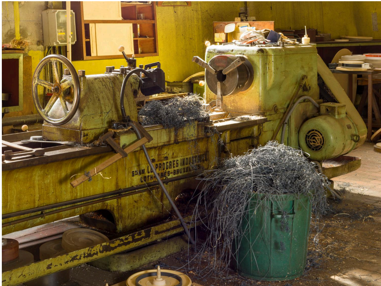
Atelier de mécanique générale (usinage). Détail du tour parallèle Le Progrès Industriel. Copeaux résultant de l'usinage de la matière plastique. Au sol, obturateur d'enceinte de confinement.
