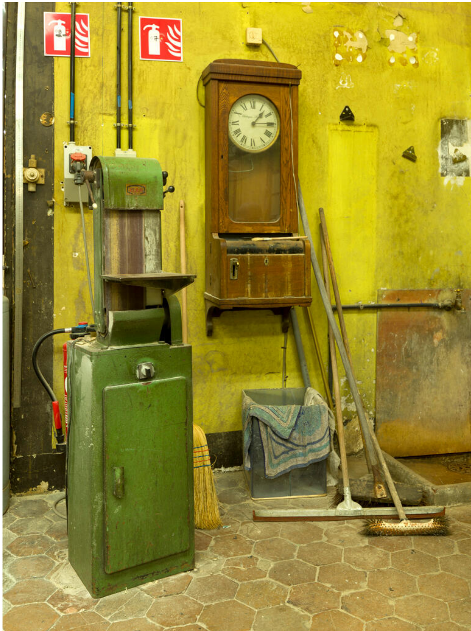
Chaudronnerie plastique. Machine à poncer (« Tank ») et ancienne pointeuse.
