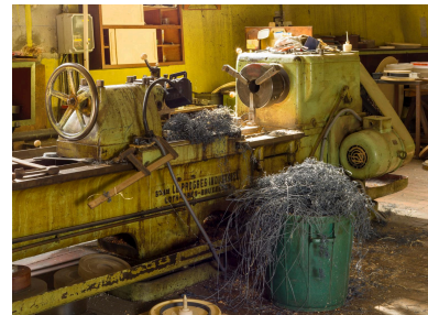
Atelier de mécanique générale (usinage). Détail du tour parallèle Le Progrès Industriel. Copeaux résultant de l'usinage de la matière plastique. Au sol, obturateur d'enceinte de confinement. Phot. Stéphane Asseline IVR11_20239400132NUC4A
