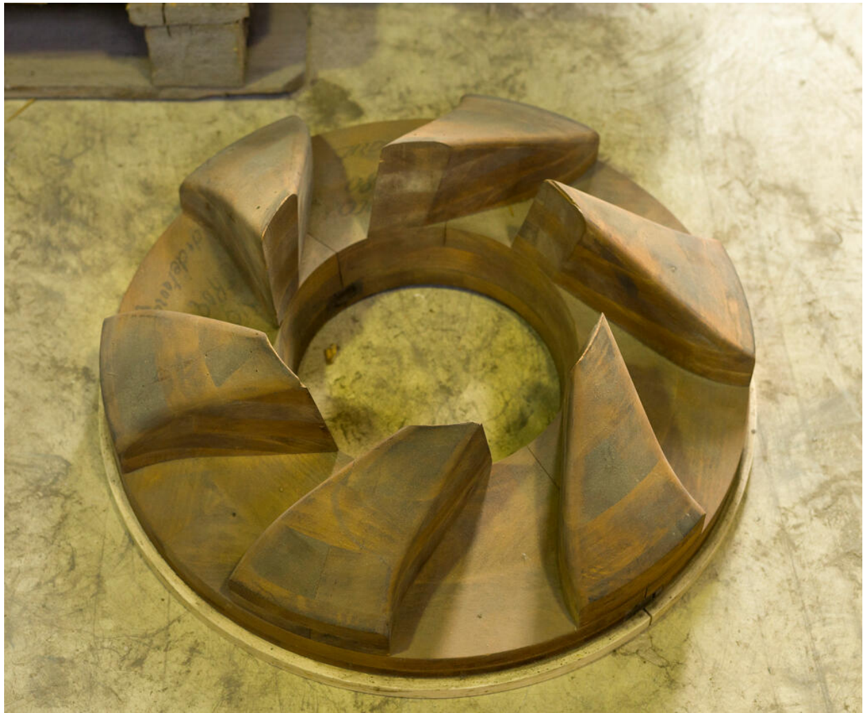
Atelier de thermoformage. Moule en lamellé-collé, usiné à la main au cours des années 1960, pour thermoformer des retors de ventilateurs en PVC d'une épaisseur de 3 millimètres.
