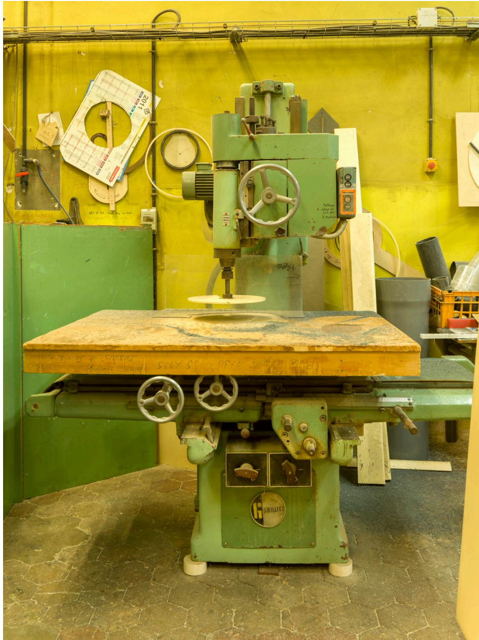
Chaudronnerie plastique. Scie circulaire horizontale.
