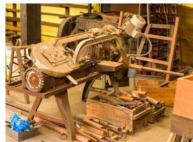
Chaudronnerie métallique. Scie à ruban pour le découpage de la matière métallique. De provenance américaine. Phot. Stéphane Asseline IVR11_20239400171NUC4A
