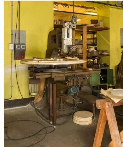
Atelier de mécanique générale (usinage). Transformation d'une fraise en tour vertical pour usinage de pièces en matières plastiques de diamètre supérieur à 1 m et inférieur 1,5 m. Phot. Asseline Stéphane IVR11_20239400144NUC4A
