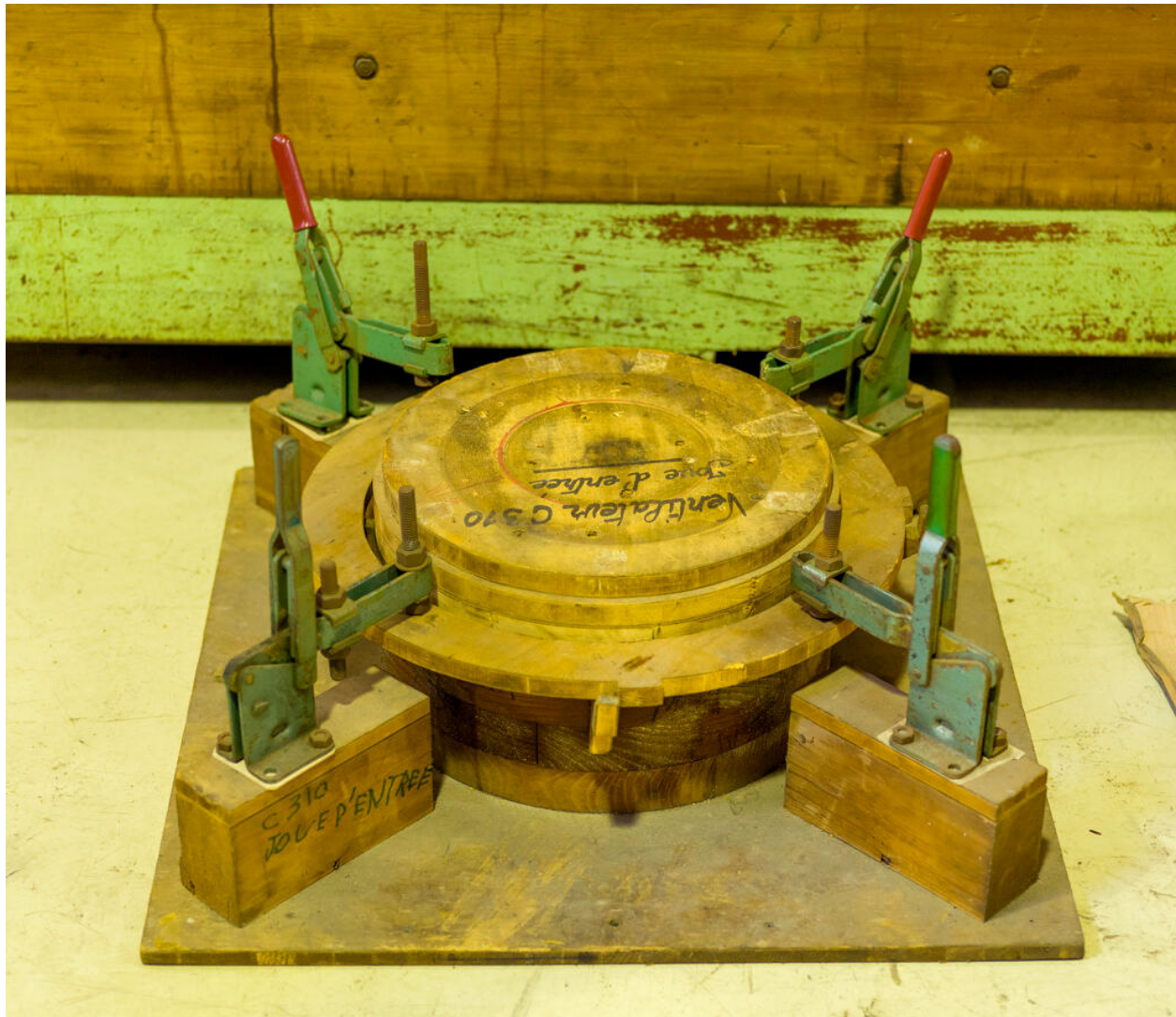
Atelier de thermoformage. Moule maintenu par des « sauterelles ».
