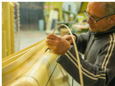
Chaudronnerie plastique. Fabrication d'une enceinte de confinement en PVC. Assemblage des éléments par soudure à air chaud. Phot. Stéphane Asseline IVR11_20239400343NUC4A
