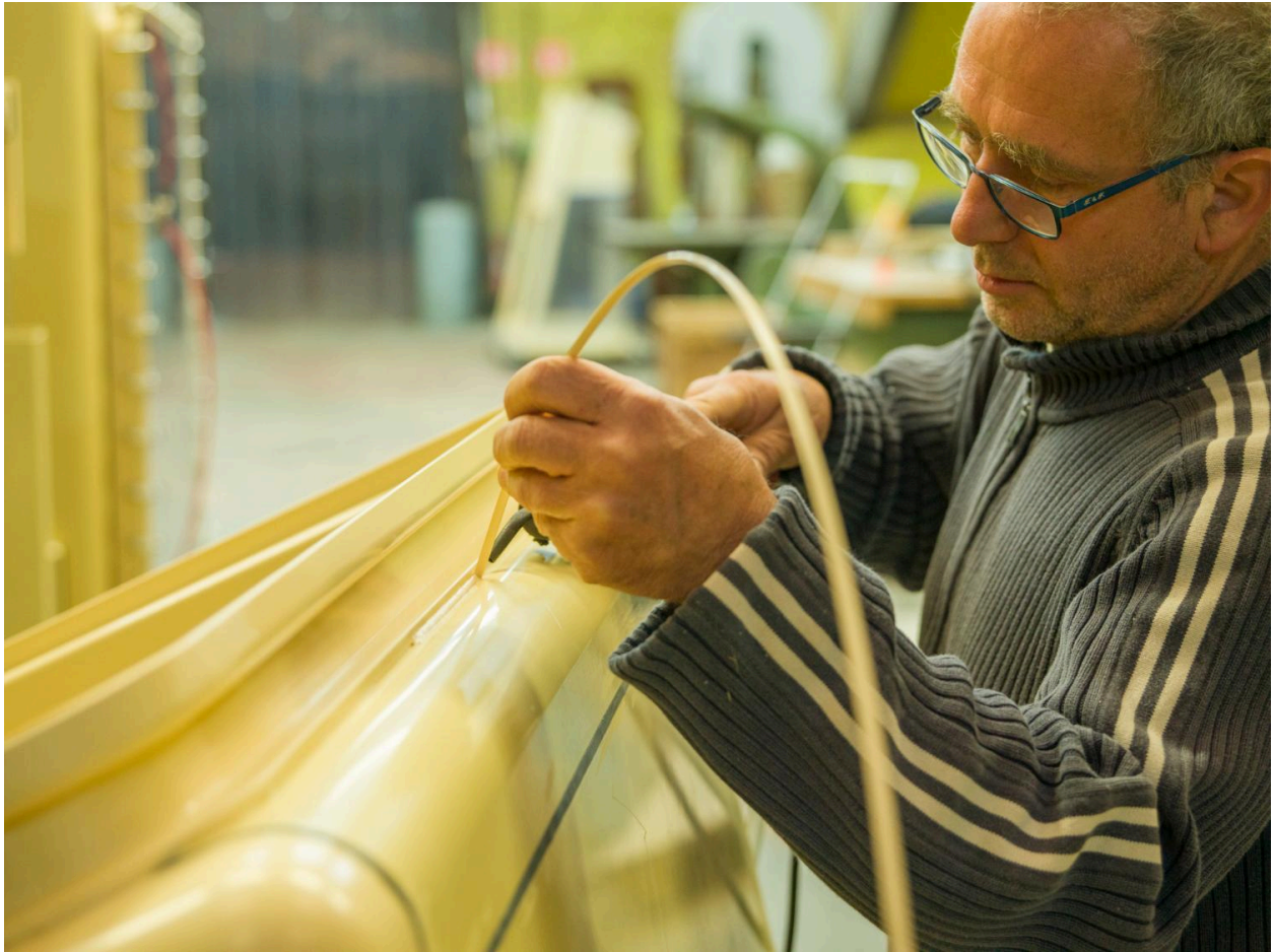
Chaudronnerie plastique. Fabrication d'une enceinte de confinement en PVC. Assemblage des éléments par soudure à air chaud.
