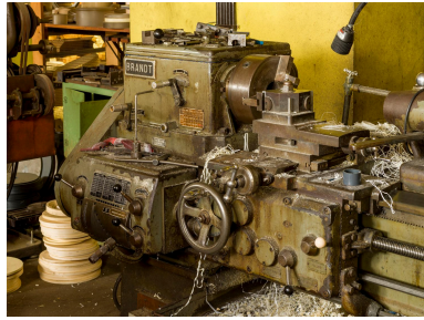
Atelier de mécanique générale (usinage). Tour parallèle conventionnel Brandt. Levier de vitesse et volant de commande. Phot. Stéphane Asseline IVR11_20239400142NUC4A
