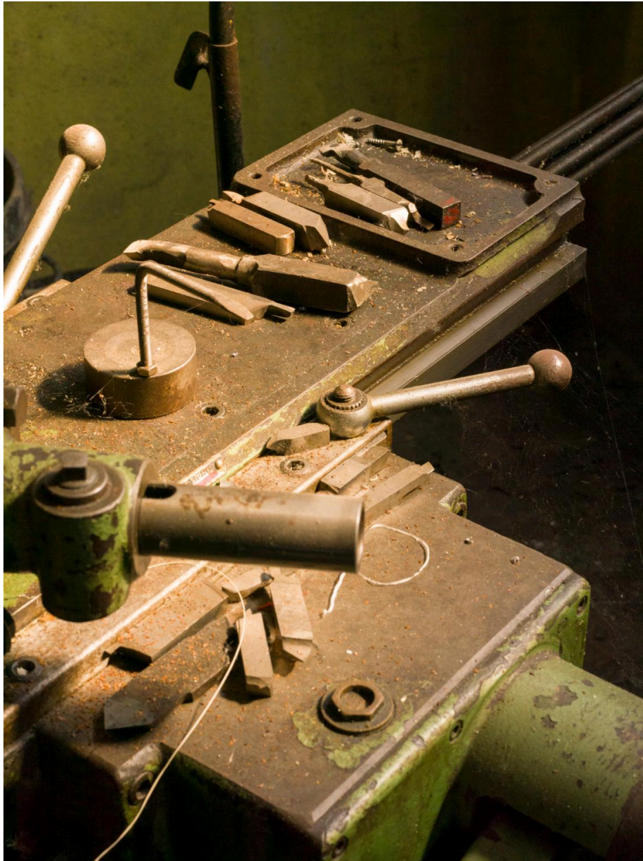
Atelier de mécanique générale (usinage). Tour semi-automatique à tourelle revolver de marque SOMUA – Noël Ernault. Détail d'outils de coupe.
