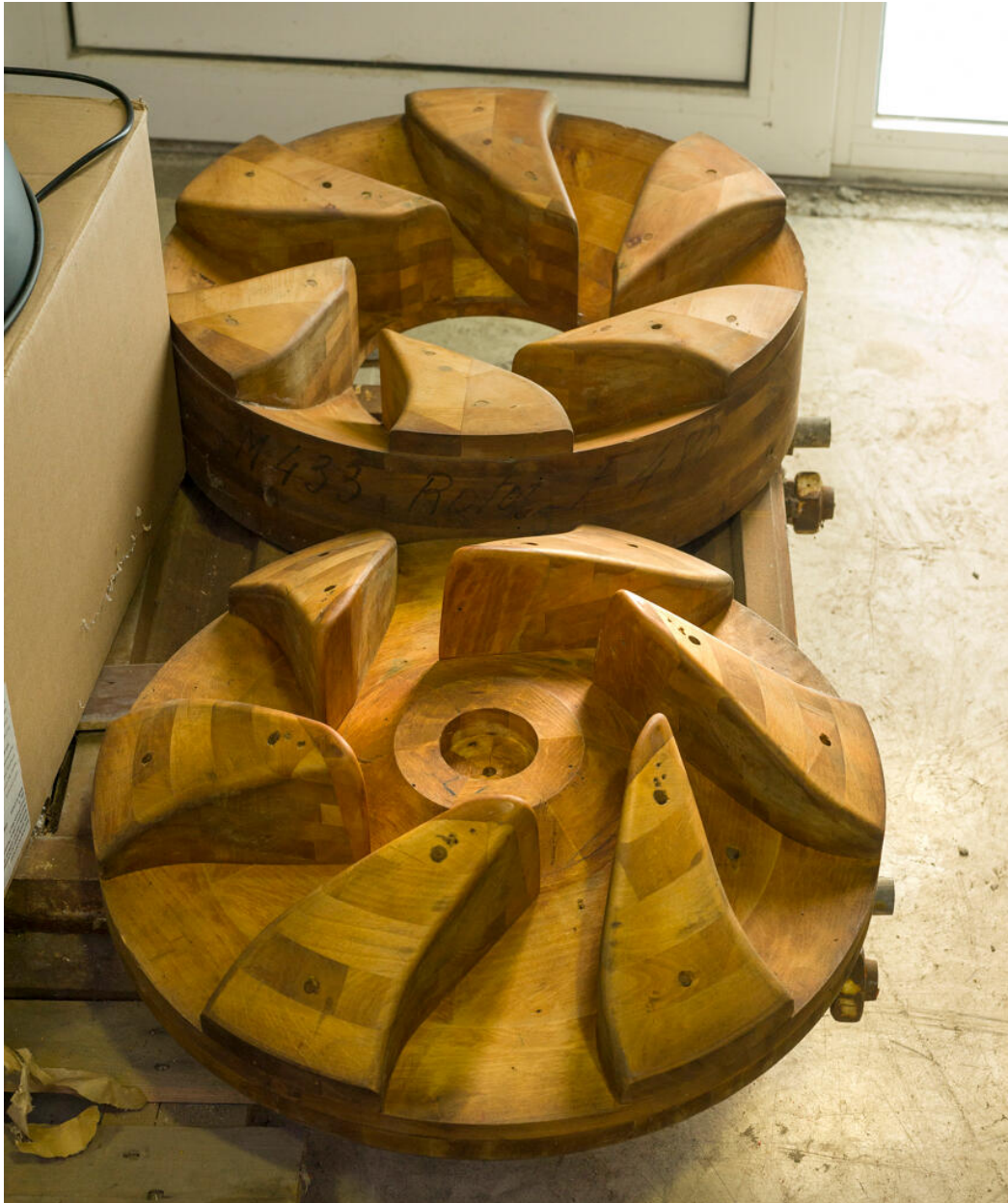
Atelier de thermoformage. Moules en lamellé-collé, usinés à la main au cours des années 1960, pour thermoformer des retors de ventilateurs en PVC d'une épaisseur de 3 millimètres.
