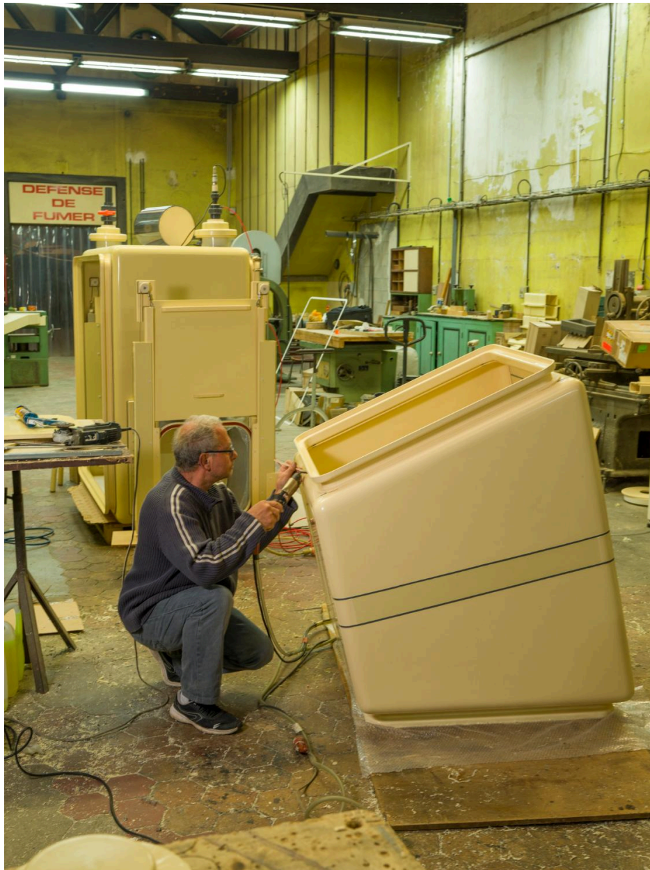
Chaudronnerie plastique. Fabrication d'une enceinte de confinement en PVC. Assemblage des éléments par soudure à air chaud.
