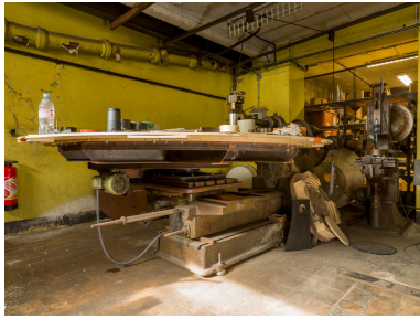
Atelier de mécanique générale (usinage). Transformation d'une ancienne aléuseuse en tour vertical pour usinage de pièces en matières plastiques de diamètre inférieur à 2,6 m. Phot. Stéphane Asseline IVR11_20239400127NUC4A
