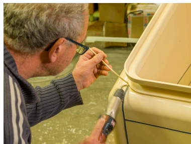
Chaudronnerie plastique. Fabrication d'une enceinte de confinement en PVC. Assemblage des éléments par soudure à air chaud. Phot. Stéphane Asseline IVR11_20239400344NUC4A
