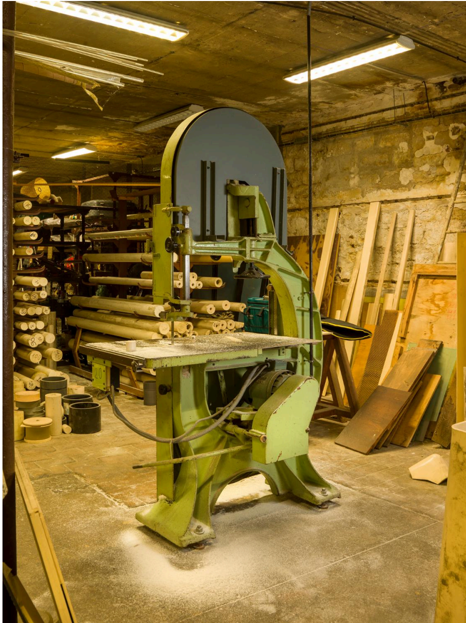
Magasin d'accessoires et de pièces détachées standards pour enceintes de confinement. Scie à ruban pour le découpage de la matière plastique.
