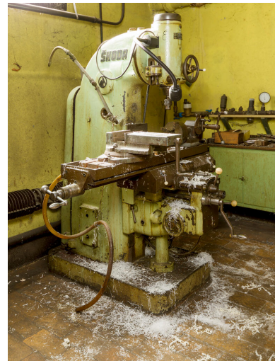
Atelier de mécanique générale (usinage). Fraiseuse verticale de marque SKODA. Tchécoslovaquie, dommage de guerre. Phot. Asseline Stéphane IVR11_20239400129NUC4A
