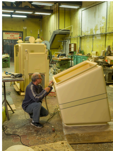
Chaudronnerie plastique. Fabrication d'une enceinte de confinement en PVC. Assemblage des éléments par soudure à air chaud. Phot. Stéphane Asseline IVR11_20239400341NUC4A
