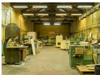
Chaudronnerie plastique, au rez-de-chaussée. Au premier plan, les machines à bois utilisées pour couper la matière plastique. À droite à l'arrière, deux enceintes de confinement en cours de fabrication.
