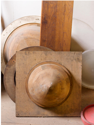
Atelier de thermoformage. Moule de forme conique. Phot. Asseline Stéphane IVR11_20239400205NUC4A
