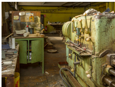
Atelier de mécanique générale (usinage). Tour parallèle Le Progrès Industriel. Leviers de la boîte de vitesse. Phot. Stéphane Asseline IVR11_20239400137NUC4A
