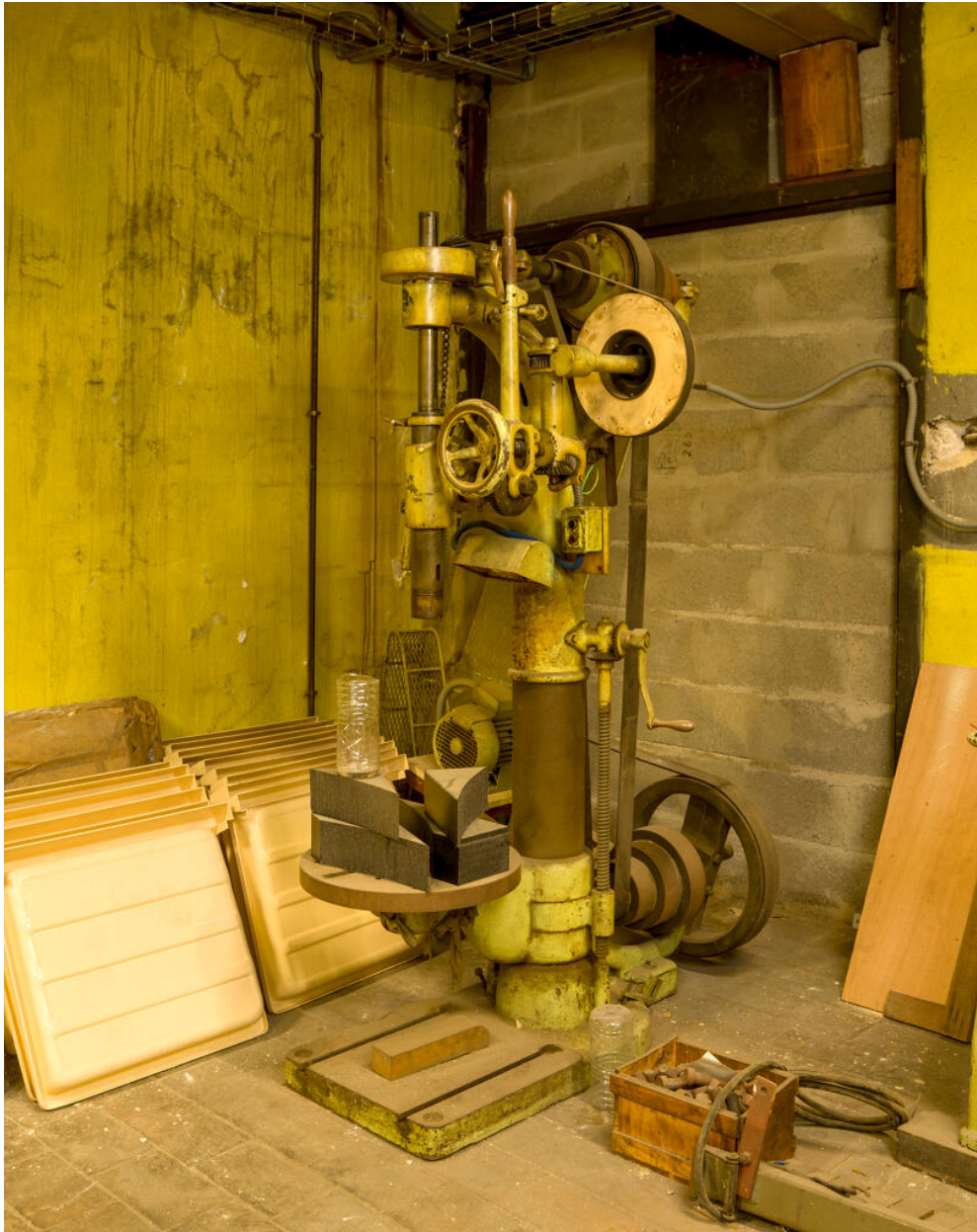
Magasin d'accessoires et de pièces détachées standards pour enceintes de confinement. Perceuse radiale (ou à colonne), transmission par courroie plate. Dommage de guerre.
