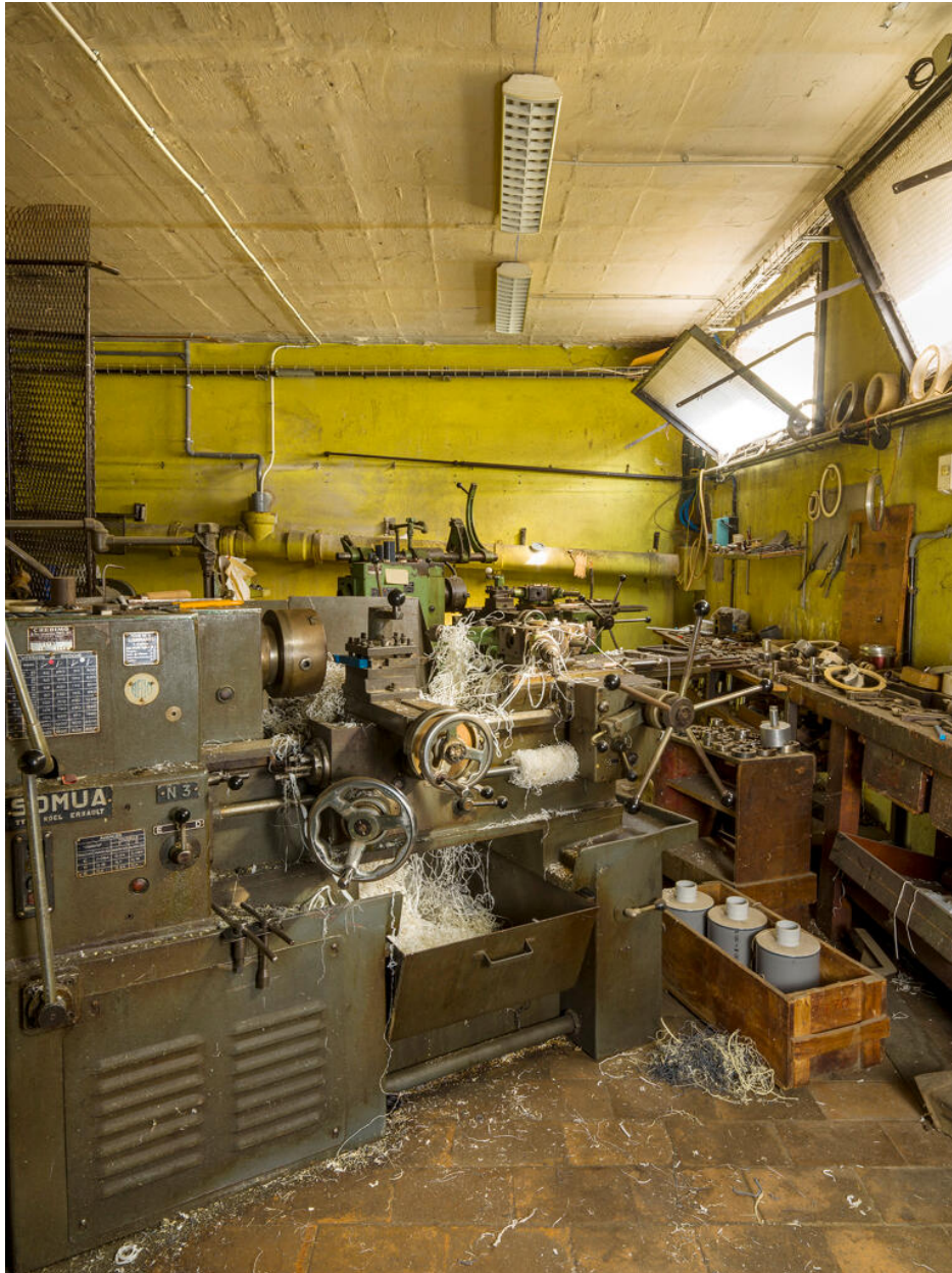
Atelier de mécanique générale (usinage). Tour semi-automatique à tourelle revolver de marque SOMUA – Noël Ernault, 1967 (dernière acquisition de l'entreprise pour l'atelier de mécanique générale).
