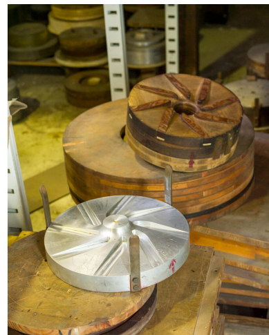
Atelier de thermoformage. Moules pour thermoformer des retors de ventilateurs en PVC. Phot. Asseline Stéphane IVR11_20239400204NUC4A
