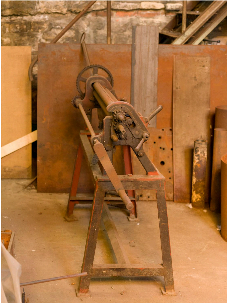
Chaudronnerie métallique. Rouleuse.
