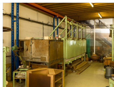
Atelier de thermoformage. Four électrique de fabrication « maison », pour le formage à chaud des matières plastiques, années 1960. Phot. Stéphane Asseline IVR11_20239400191NUC4A
