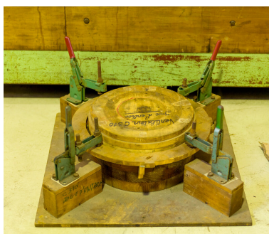
Atelier de thermoformage. Moule maintenu par des « sauterelles ». Phot. Asseline Stéphane IVR11_20239400197NUC4A
