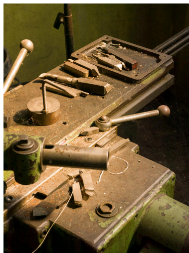
Atelier de mécanique générale (usinage). Tour semi-automatique à tourelle revolver de marque SOMUA – Noël Ernault. Détail d'outils de coupe. Phot. Stéphane Asseline IVR11_20239400155NUC4A
