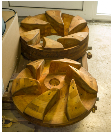
Atelier de thermoformage. Moules en lamellé-collé, usinés à la main au cours des années 1960, pour thermoformer des retors de ventilateurs en PVC d'une épaisseur de 3 millimètres. Phot. Asseline Stéphane IVR11_20239400199NUC4A
