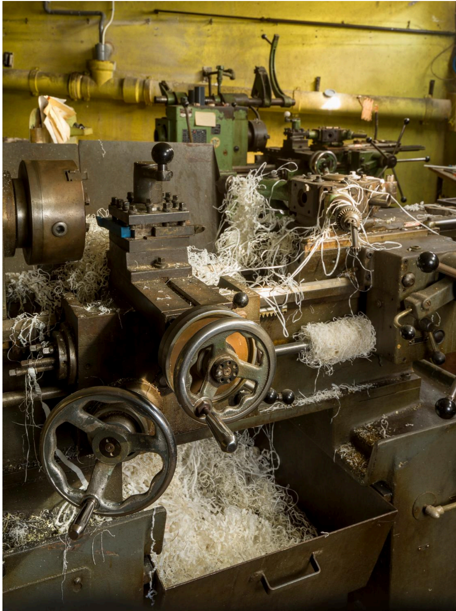
Atelier de mécanique générale (usinage). Tour semi-automatique à tourelle revolver de marque SOMUA – Noël Ernault. Volants de commande.
