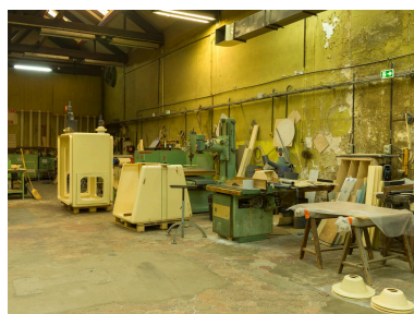
Chaudronnerie plastique, au rez-de-chaussée. Deux enceintes de confinement en cours de fabrication. Phot. Stéphane Asseline IVR11_20239400179NUC4A
