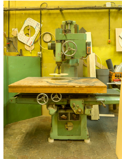
Chaudronnerie plastique. Scie circulaire horizontale.
