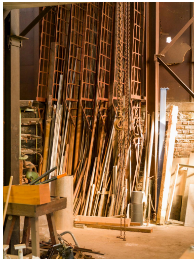
Chaudronnerie métallique. Casier de rangement de profilés aciers. Phot. Stéphane Asseline IVR11_20239400172NUC4A
