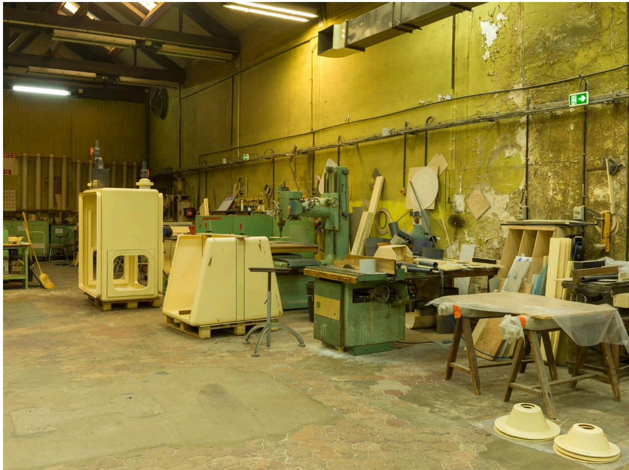
Chaudronnerie plastique, au rez-de-chaussée. Deux enceintes de confinement en cours de fabrication.
