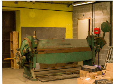
Chaudronnerie métallique. Plieuse manuelle de marque BOMBLED-PARIS, pour plier des tôles jusqu'à 4 millimètres d'épaisseur. Phot. Stéphane Asseline IVR11_20239400167NUC4A
