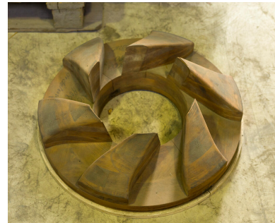
Atelier de thermoformage. Moule en lamellé-collé, usiné à la main au cours des années 1960, pour thermoformer des retors de ventilateurs en PVC d'une épaisseur de 3 millimètres. Phot. Asseline Stéphane IVR11_20239400201NUC4A
