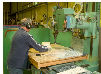
Chaudronnerie plastique. Découpe d'un élément de ventilateur centrifuge en PVC avec une scie circulaire horizontale. Phot. Stéphane Asseline IVR11_20239400345NUC4A
