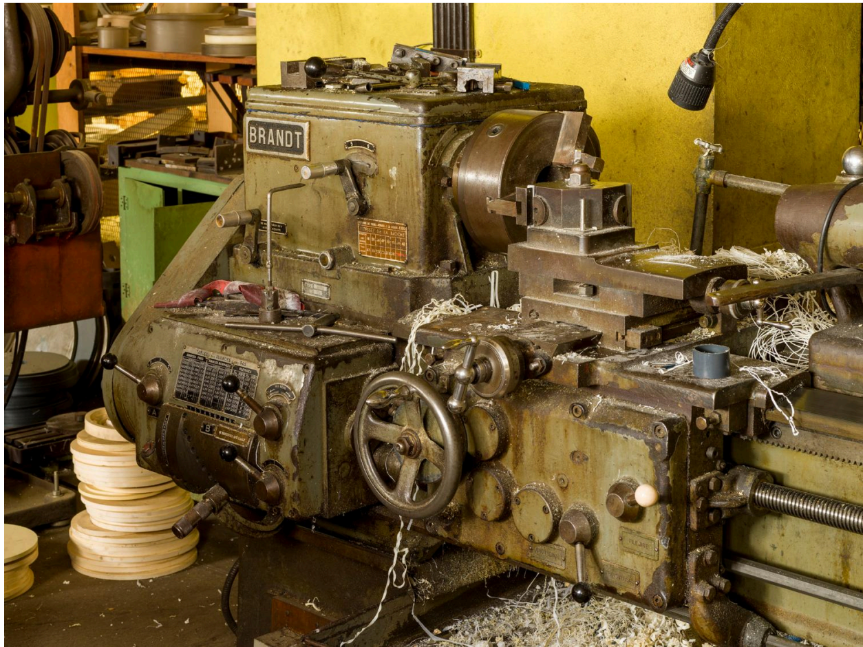
Atelier de mécanique générale (usinage). Tour parallèle conventionnel Brandt. Levier de vitesse et volant de commande.
