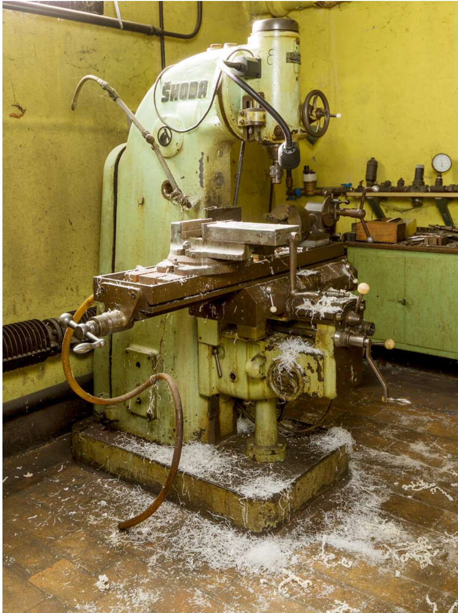
Atelier de mécanique générale (usinage). Fraiseuse verticale de marque SKODA. Tchécoslovaquie, dommage de guerre.
