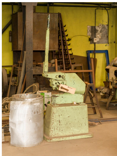
Chaudronnerie métallique. Cisaille à main. Phot. Stéphane Asseline IVR11_20239400169NUC4A
