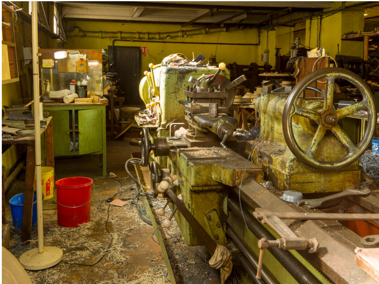
Atelier de mécanique générale (usinage). Tour parallèle Le Progrès Industriel.
