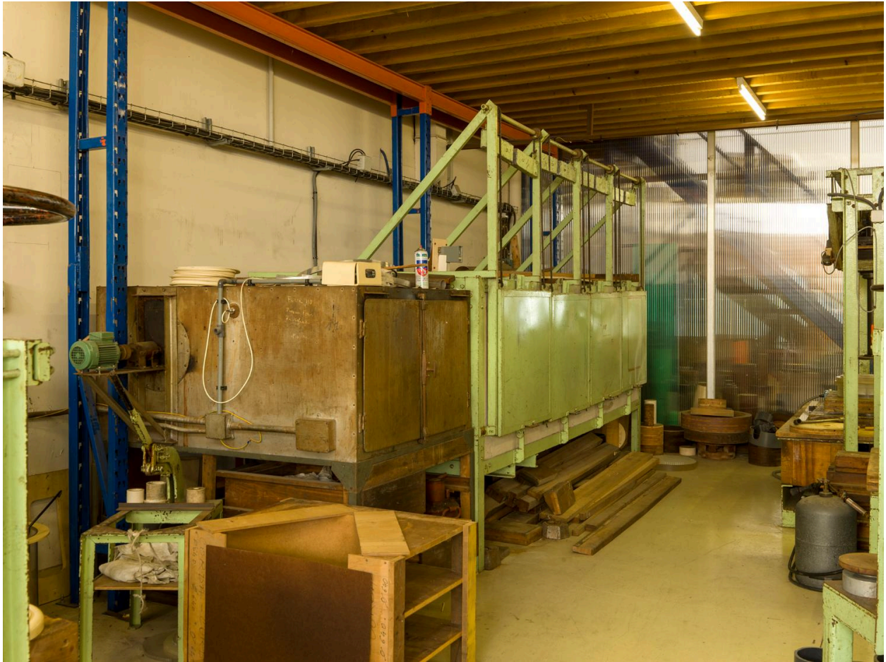
Atelier de thermoformage. Four électrique de fabrication « maison », pour le formage à chaud des matières plastiques, années 1960.
