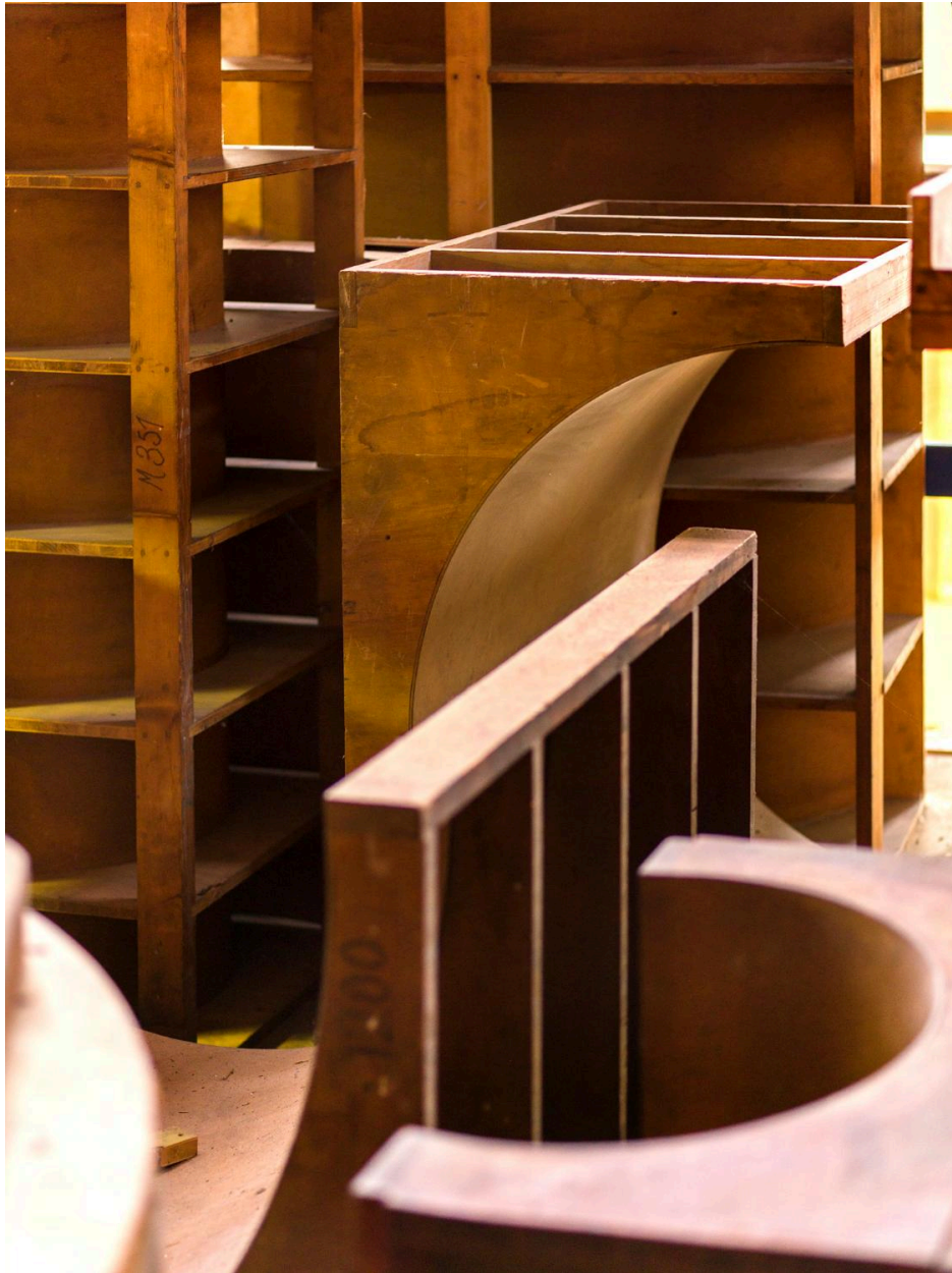
Atelier de thermoformage. Berceaux destinés à la fabrication de pièces cylindriques de grand diamètre.
