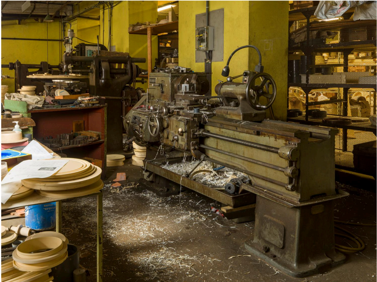
Atelier de mécanique générale (usinage). Tour parallèle conventionnel de marque Brandt, acquis dans les années 1950.
