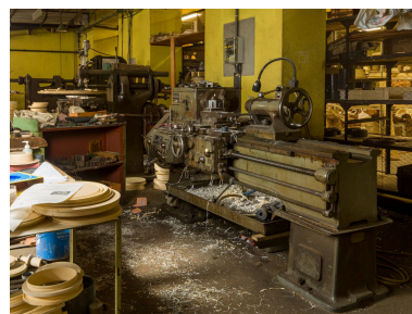
Atelier de mécanique générale (usinage). Tour parallèle conventionnel de marque Brandt, acquis dans les années 1950. Phot. Stéphane Asseline IVR11_20239400141NUC4A
