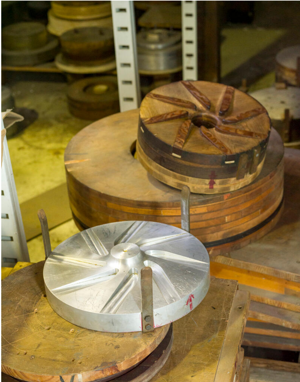
Atelier de thermoformage. Moules pour thermoformer des retors de ventilateurs en PVC.
