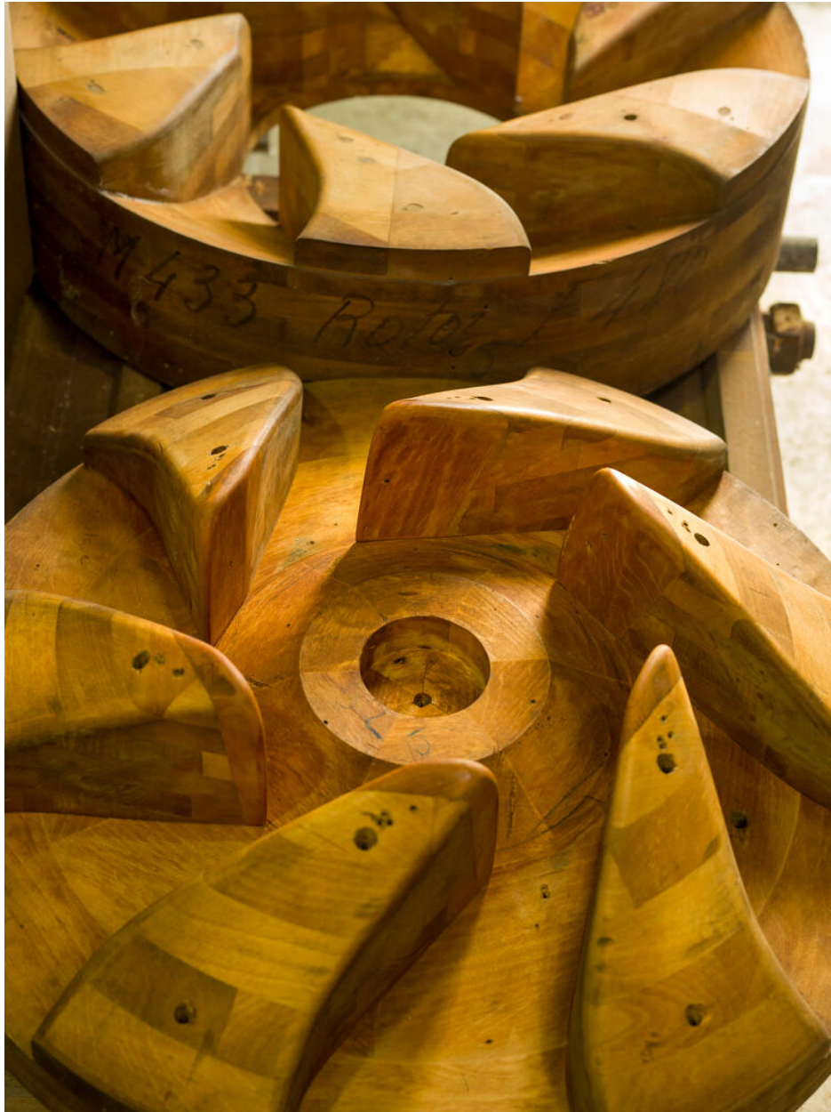
Atelier de thermoformage. Moules en lamellé-collé, usinés à la main au cours des années 1960, pour thermoformer des retors de ventilateurs en PVC d'une épaisseur de 3 millimètres.
