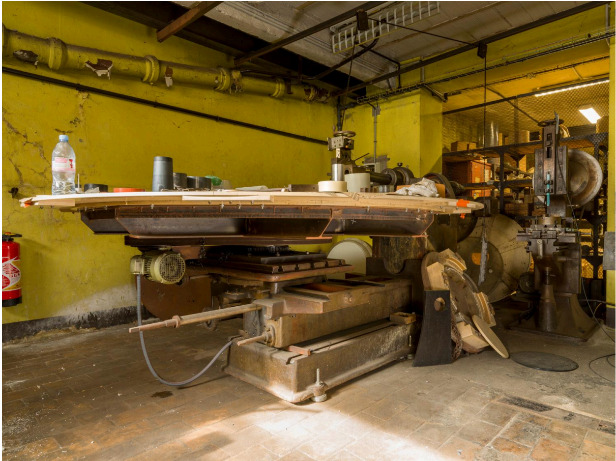
Atelier de mécanique générale (usinage). Transformation d'une ancienne aléseuse en tour vertical pour usinage de pièces en matières plastiques de diamètre inférieur à 2,6 m.
