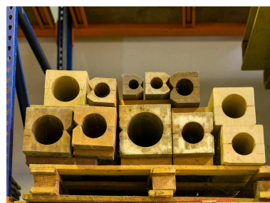
Atelier de thermoformage. Moules de fabrication. Phot. Stéphane Asseline IVR11_20239400198NUC4A
