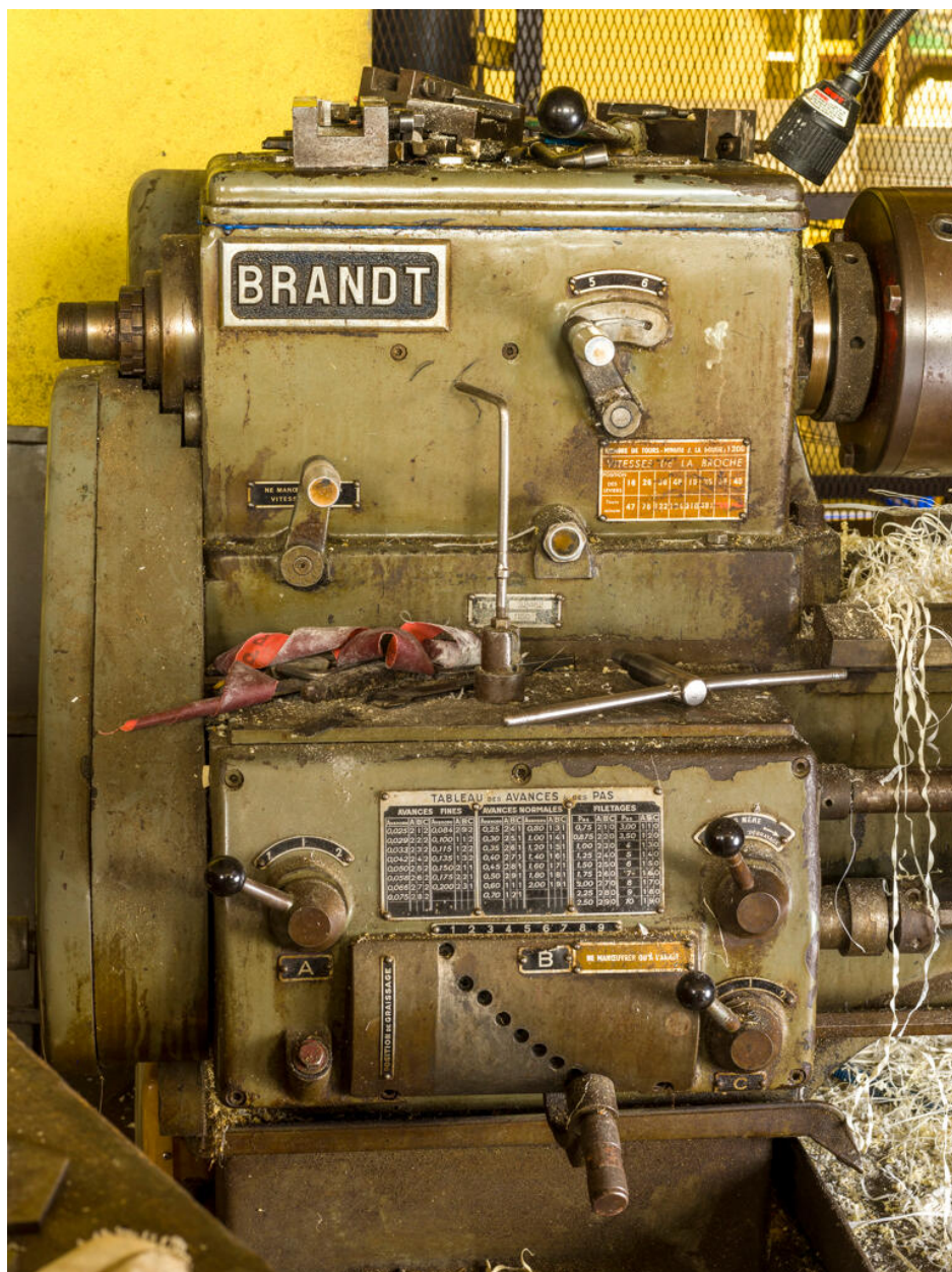
Atelier de mécanique générale (usinage). Tour parallèle conventionnel Brandt. Boîte de vitesse.
