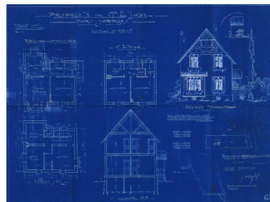
Plans de la maison de M. Eliabel (type n° 3 augmenté) : implantation, élévation principale, coupe et plans par niveaux. (Société coopérative ""Paris- Jardins"" de Draveil, dossier 172) Phot. Philippe Ayrault, Autr. L. (architecte) Clément-Camus, Autr. R. (architecte) Larminat IVR11_20069100958XA
